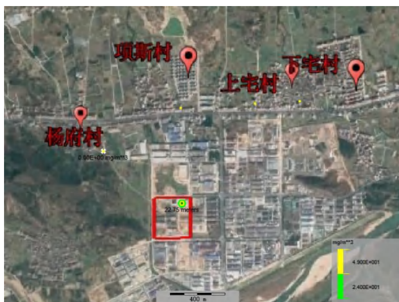
图 6.3.5-3 乙二胺储罐泄漏影响预测图（最常见气象条件）
