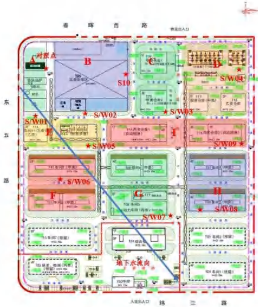
图1 土壤和地下水监测井布设位置图
